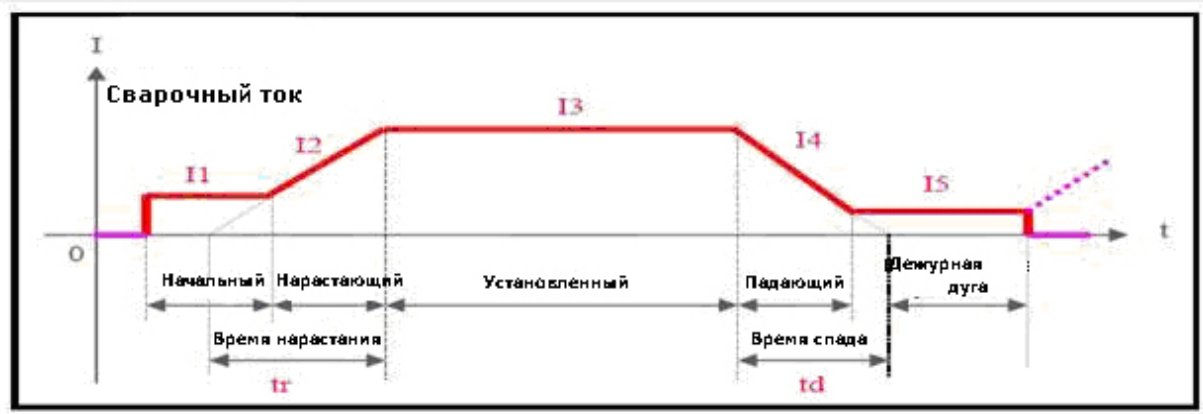
Рис. 7.4 График изменения сварочного тока в процессе TIG – сварки (ток пост.)
