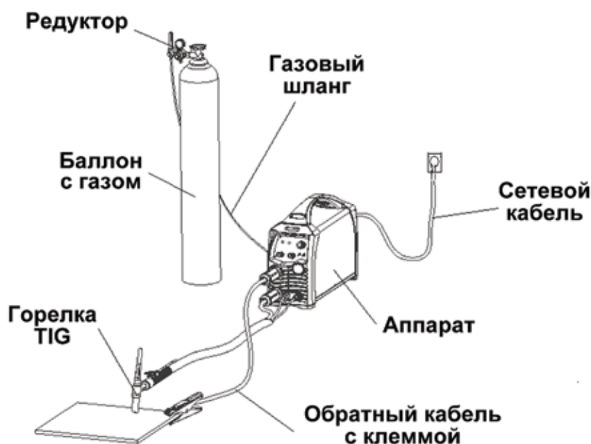
Рис. 6.2 Схема подключения оборудования для TIG сварки
