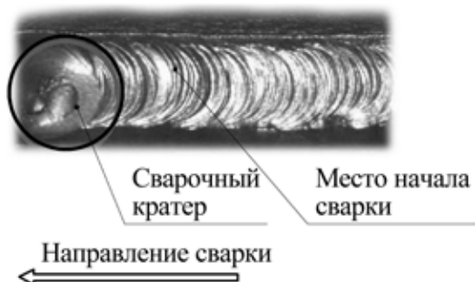
Рис. 9.4. Начало сварки при смене электрода.
