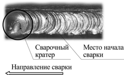
Рис. 9.4. Начало сварки при смене электрода.
