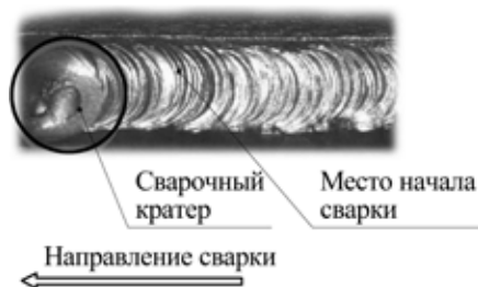
Рис. 9.4. Начало сварки при смене электрода.
