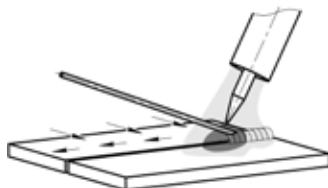
Рис. 8.6. Пример манипуляции присадочной проволокой при TIG сварке.
