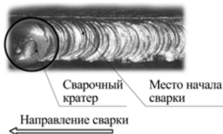
Рис. 9.4. Начало сварки при смене электрода.
