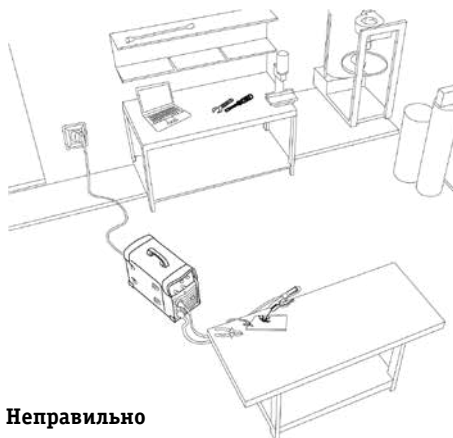
Рис. 8.4. Подключение оборудования к электрической сети.
