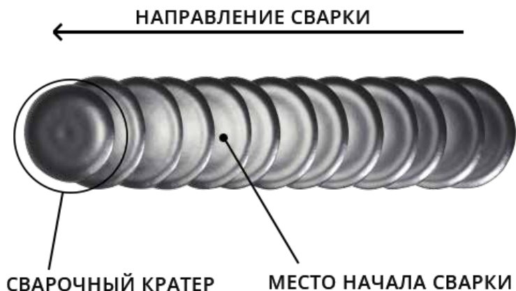
Рис. 12.4. Начало сварки при смене электрода.
