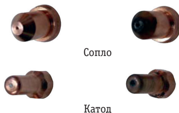
Рис. 7.6. Износ сопла и катода.
