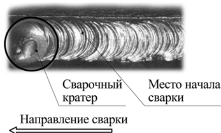
Рис. 7.4. Начало сварки при смене электрода.
