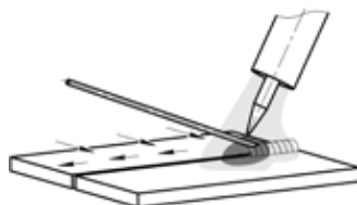
Рис. 8.6. Пример манипуляции присадочной проволокой при TIG сварке.
