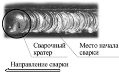
Рис. 10.4. Начало сварки при смене электрода.
