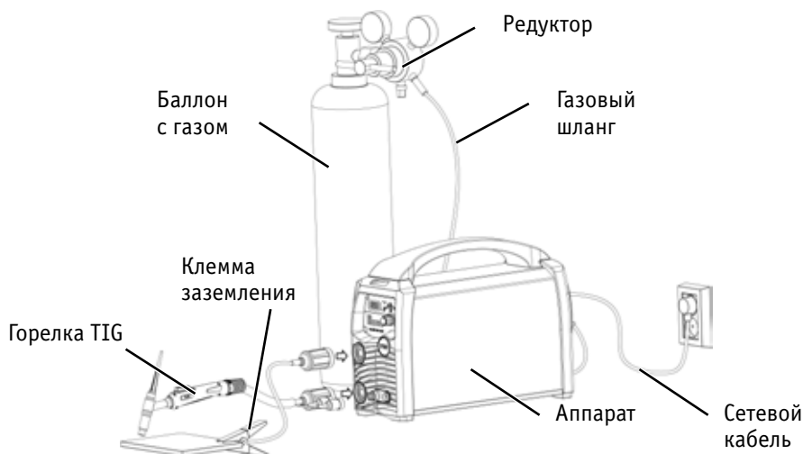
Рис. 8.1. Схема подключения оборудования.
