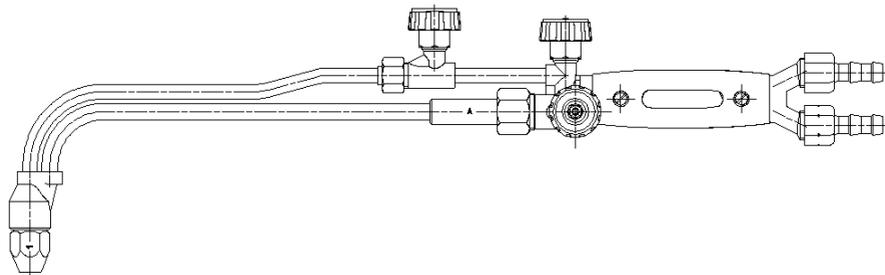
Резак состоит из ствола и наконечника, соединенных между собой.
