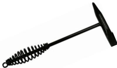
Молоток сварщика шлакоотбойный является вспомогательным инструментом при выполнении электросварочных работ. При помощи этого молотка сварщик может отбивать шлак и налипшие брызги металла на поверхности свариваемого изделия. Молоток изготовлен из прочной высококачественной стали. Рукоятка выполнена в виде пружинной спирали, которая смягчает отдачу при нанесении ударов о металл, и тем самым снимает нагрузку с кисти руки.
